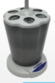
El sistema de lámpara y reflector UV-C destruye el 99% de ácidos nucleicos
